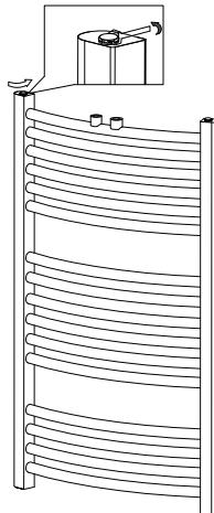
**Schritt 2:** Schrauben Sie das Heizelement mit dem Schraubenschlüssel fest auf den Heizkörper (im Uhrzeigersinn).
